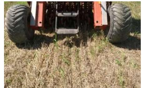
*Semis direct : un sillon est ouvert puis refermé après dépose de la graine, l'inter-rang n'est pas travaillé, la perturbation du sol est minimale.*
