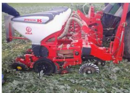
*Détail sur l'élément semeur Sola version SD avec disque ouvreur « turbo » et réglage de la profondeur de semis par roue de jauge accolée au disque semeur.*
