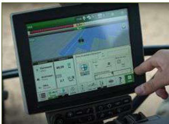
Les systèmes de guidage du tracteur par GPS ou caméra se démocratisent peu à peu en agriculture. En dépit de leur haute précision et plus grande répétabilité de positionnement, selon les conditions de la parcelle (dévers, type du terrain...) et les conditions de passage (stade de végétation...), les outils ne suivent pas toujours parfaitement la trajectoire du tracteur. Pour y pallier, des systèmes de guidage actif d'outils existent évitant ainsi la dérive.
