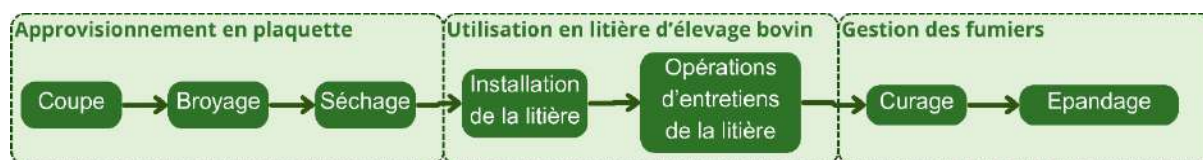
Figure 9 : Itinéraire de production et utilisation de la plaquette de bois en litière (de l'auteur, 2025)
