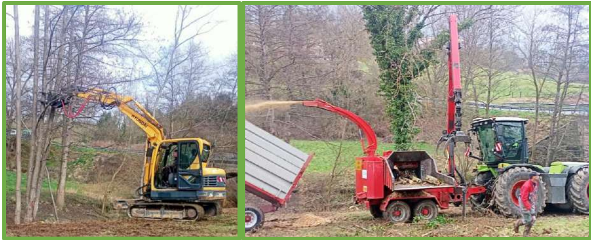
Figure 8 : Photos à gauche d'une pelleteuse équipé d'un grappin coupeur sectionnant un aulne et à droite d'un broyeur à plaquettes attelé à un tracteur (de l'auteur, 2025)
