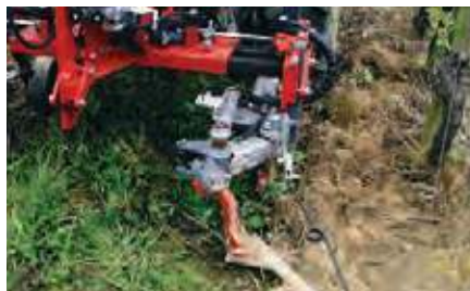
Pour gagner en sensibilité et réactivité des outils, certains constructeurs proposent des palpeurs à commande par électrodistributeur et une sécurité hydraulique.
